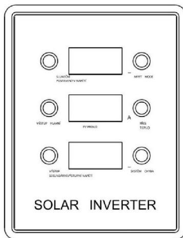
**SOLÁRNÍ STAV** - když je fotovoltaické napětí větší než 80% jmenovitého napětí zařízení, indikátor se rozsvítí. Jinak bude blikat.
